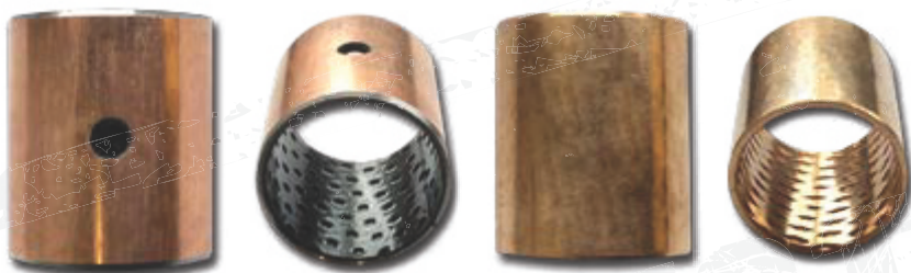
● Gleitlagerbuche WX (geschlitzt mit Bohrung und Kunststoffinnenbeschichtung)
