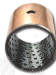
● Gleitlagerbuche WX (geschlitzt mit Bohrung und Kunststoffinnenbeschichtung)
